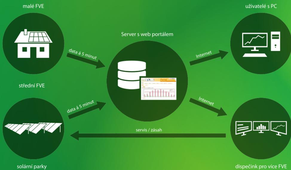
**Webový portál systému Solar Monitor nabízí funkce pro detailní analýzu provozu Vaší elektrárny. Umožňuje dohled na Vaši FVE i bez veřejné IP adresy, zobrazení detailních charakteristik, dlouhodobou diagnostiku střídačů a stringboxů, audit, archivaci a možnost editace faktur.**
